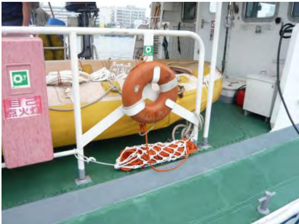
写真2 救命浮環の格納場所
