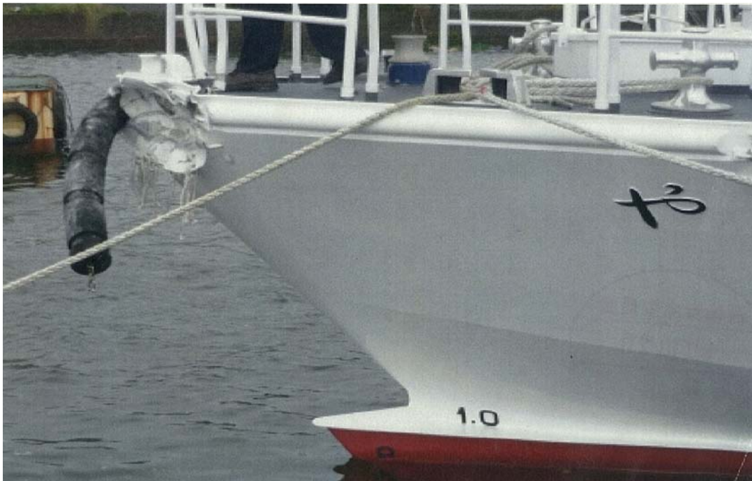
写真1 本船の損傷状況
