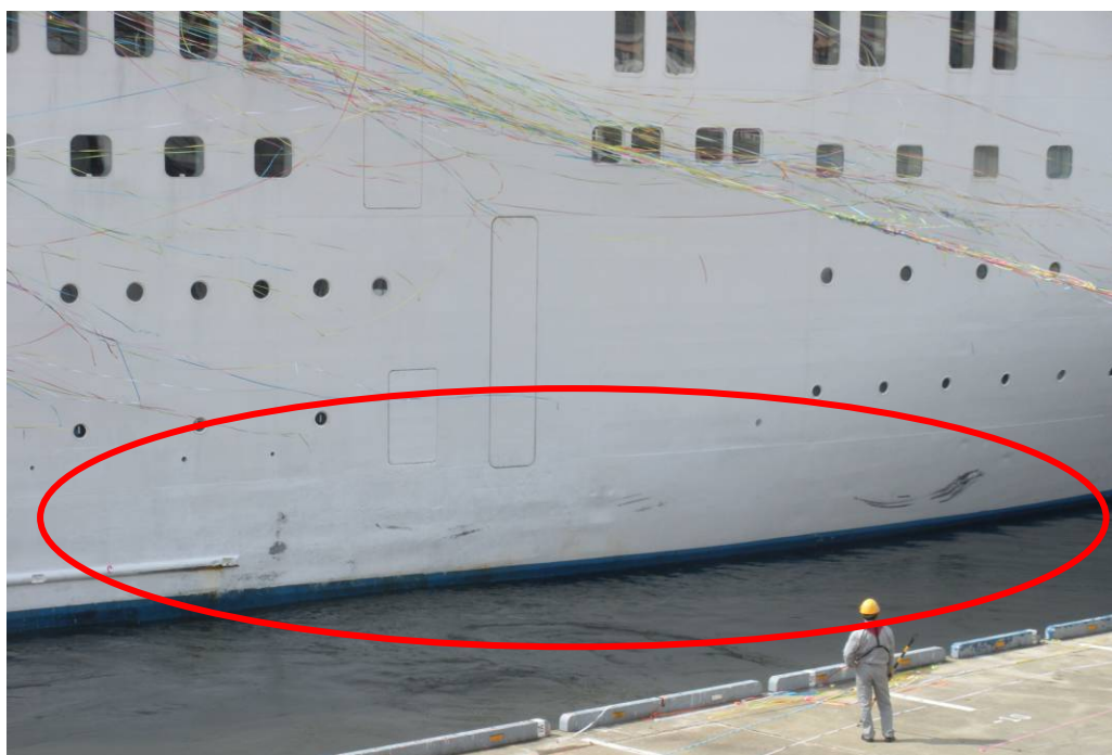
写真7 A船右舷船首部損傷状況
