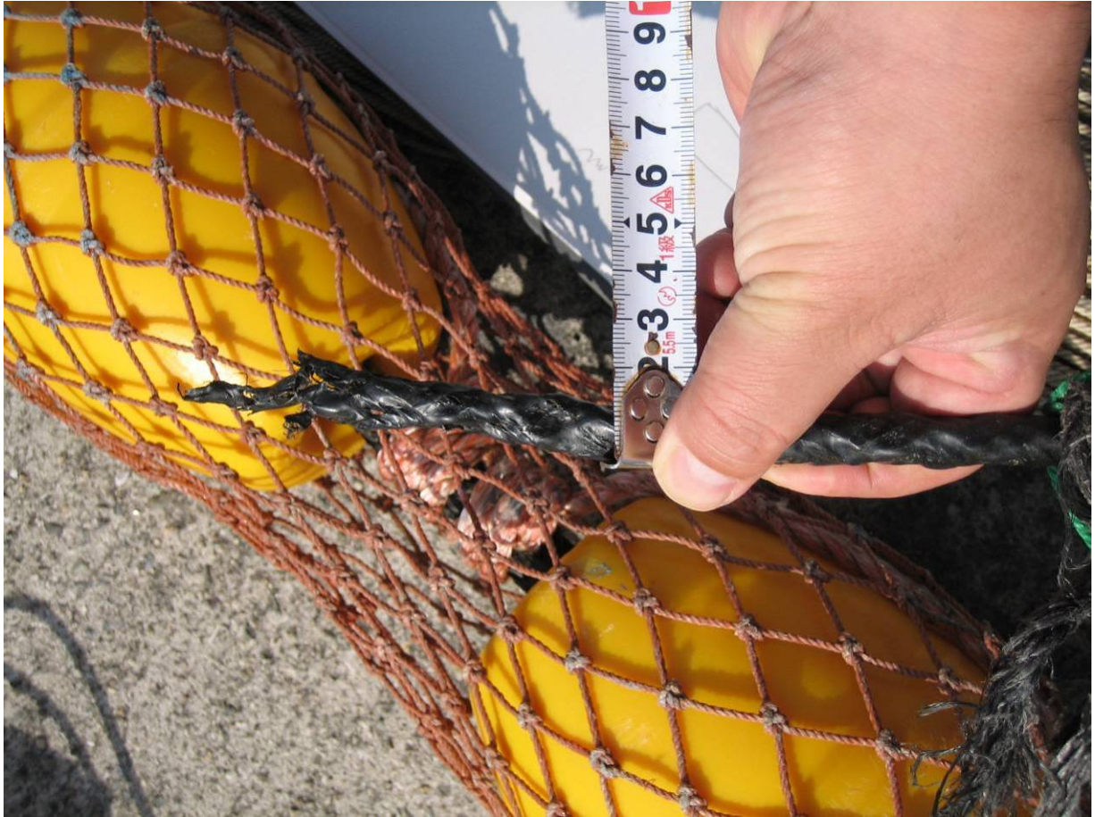
写真9 B船のえい網索切断状況
