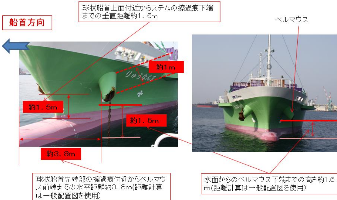
図8 A船の損傷部の位置略図
