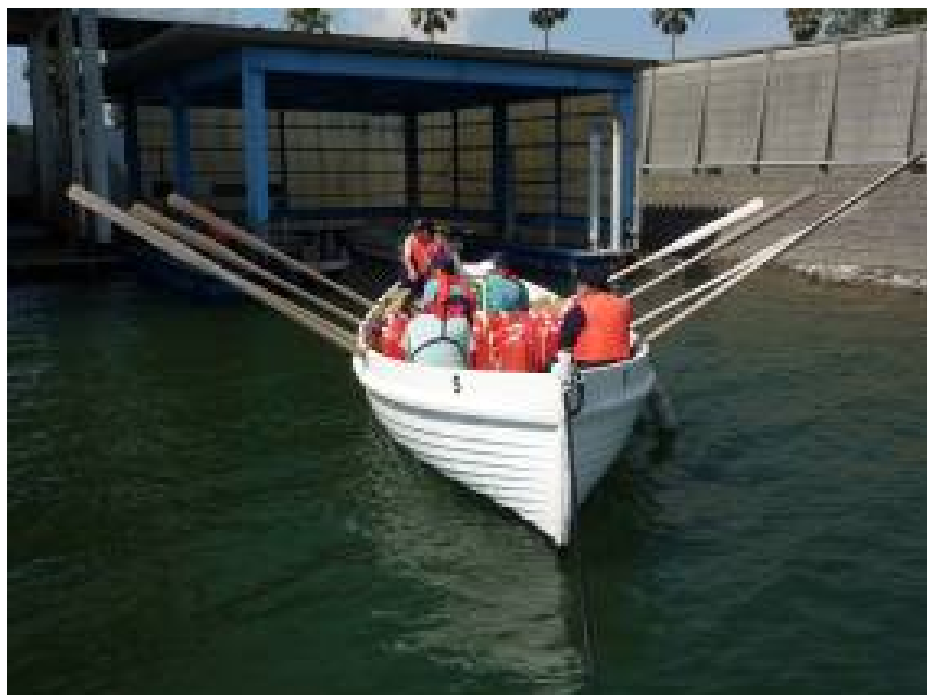
写真 2 6 海技研による調査（動揺試験）の状況
