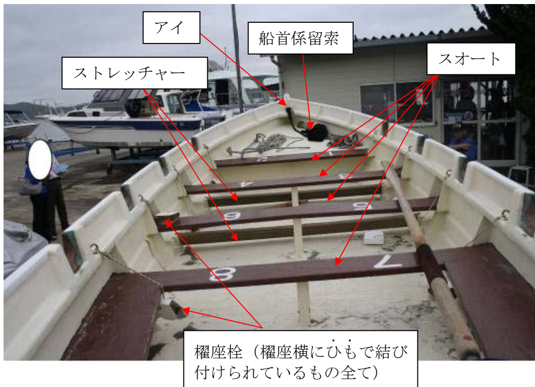
写真4 A船（船内船首側）の状況
