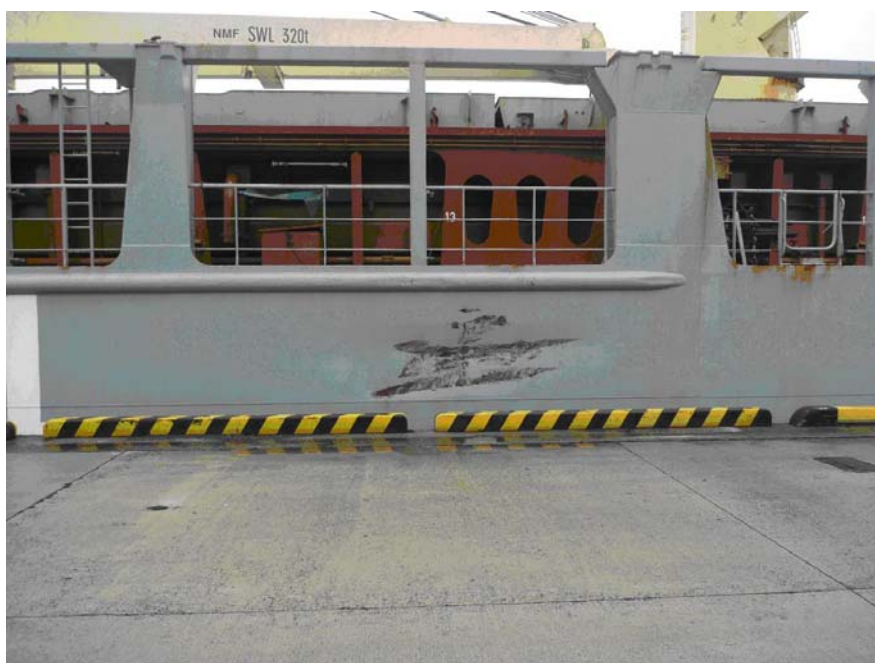
写真2 A船右舷中央部の損傷状況
