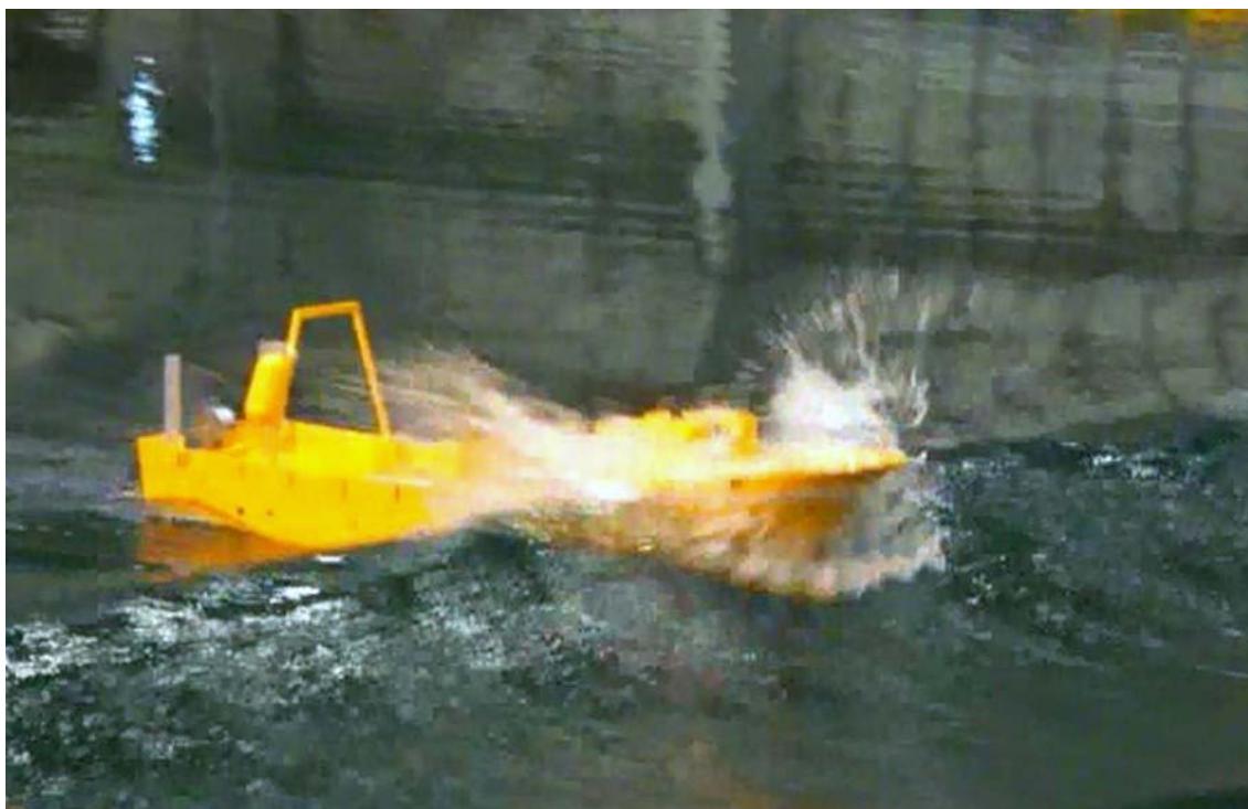
写真6 波の打ち込み状況
