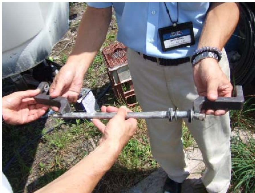
写真3 B船の船外機油圧シリンダの損傷状況
