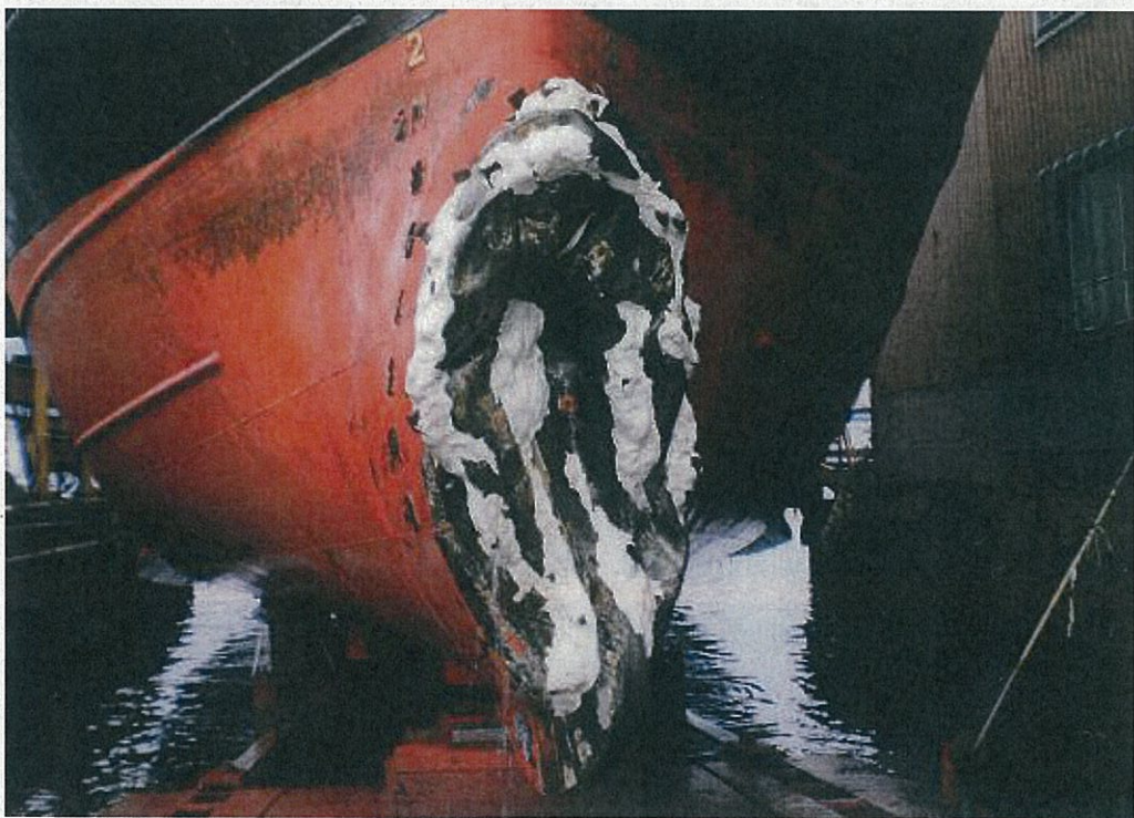
写真2 バルバスバウ損傷状況（その2）
