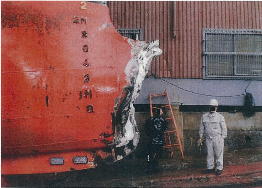
写真1 バルバスバウ損傷状況（その1）
