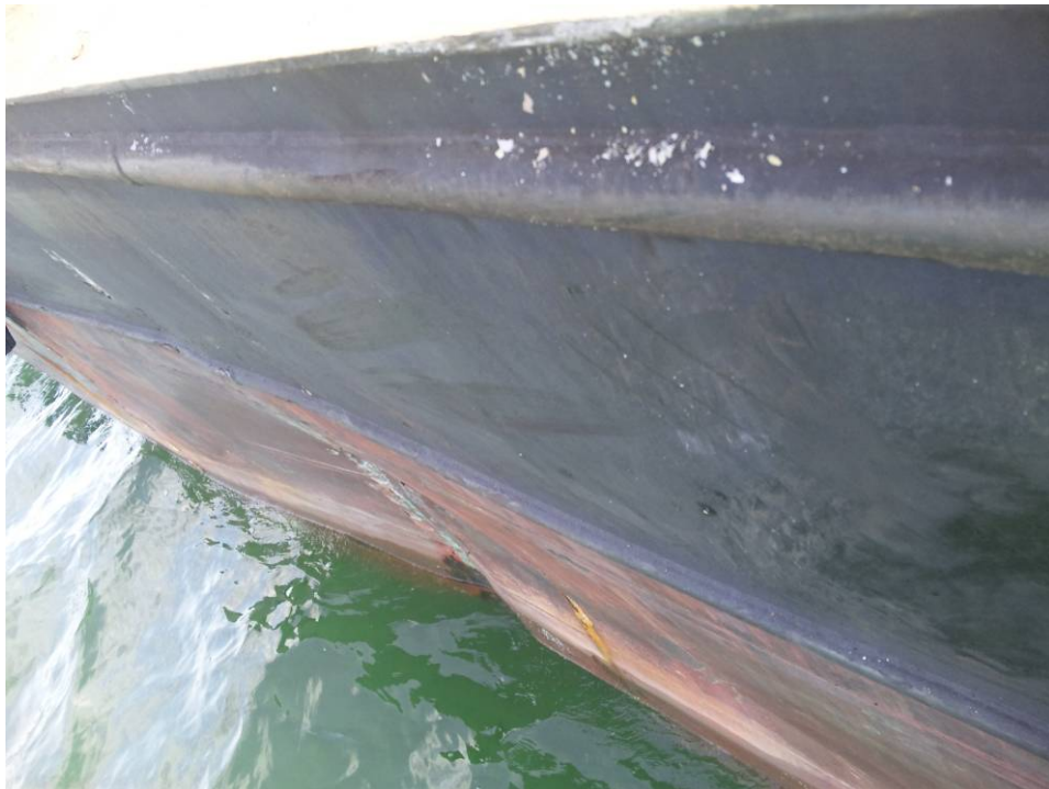
写真4 本件台船の損傷状況（左舷船首部）
