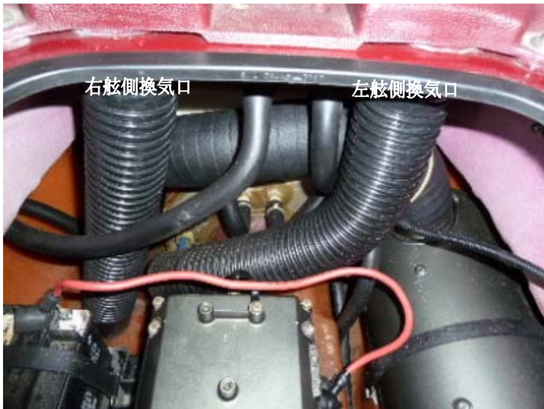
写真8 後方の換気口のフレキシブルホース
