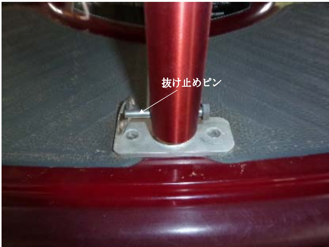
写真10 船尾のポール取付部
