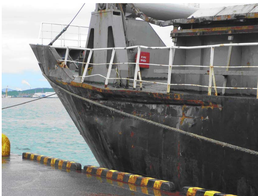
写真2 B船の左舷船首部の損傷状況
