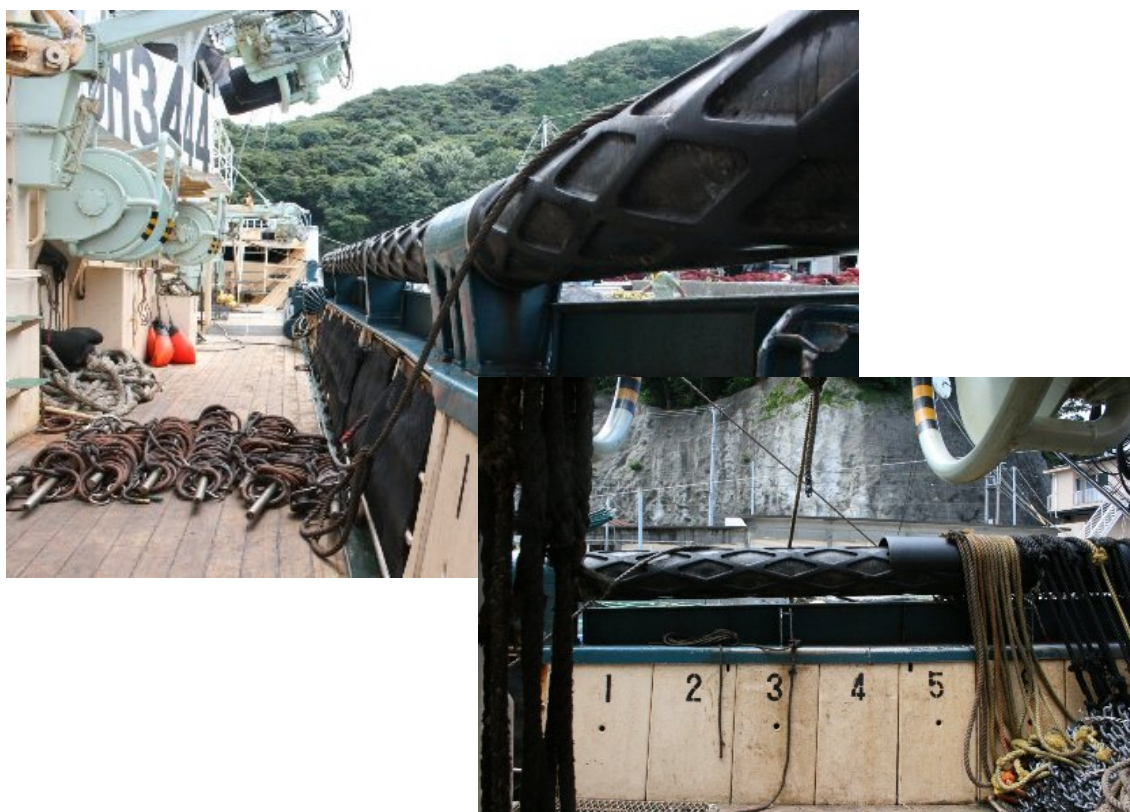
写真4 揚網用サイドローラー (類似船)
