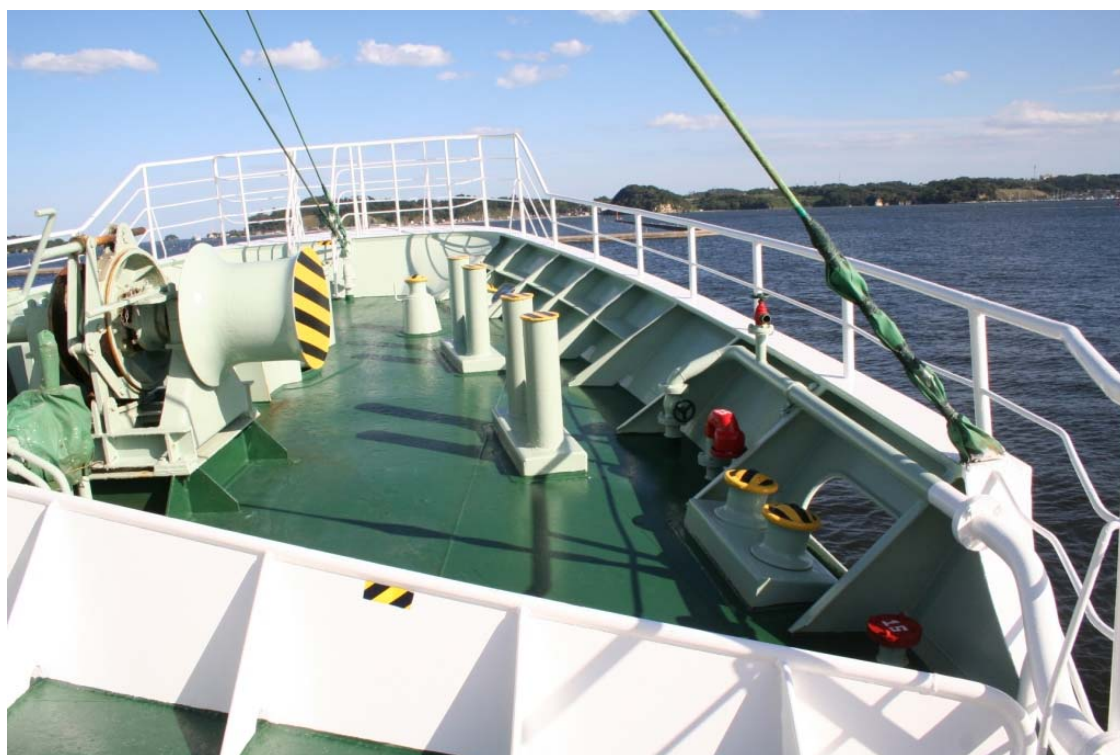
写真2 船首甲板右舷側のボラードの状況
