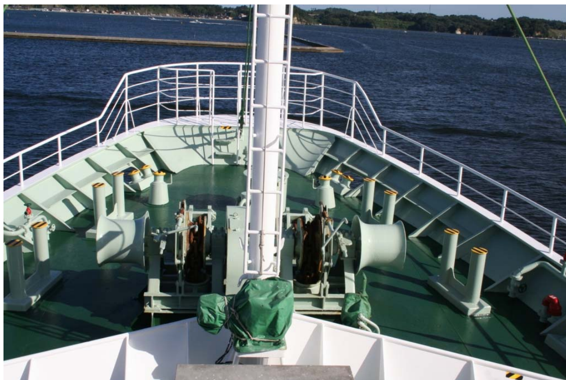
写真3 船首甲板のボラード、ウインドラス等の配置状況
