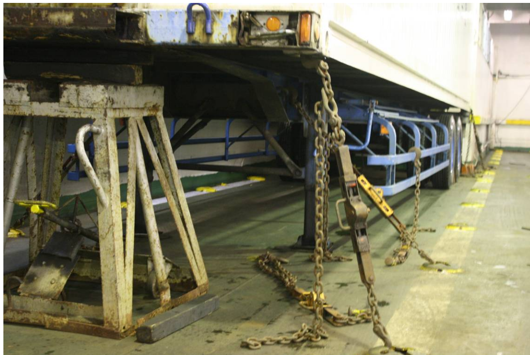
写真5 シャーシの固縛状態（6点取り）
