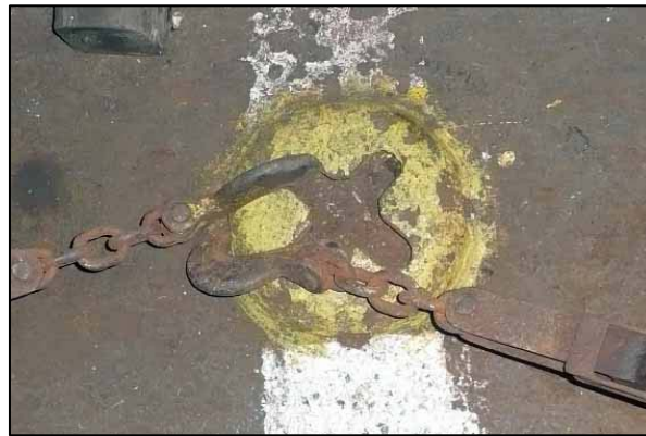
フックとクローバーリーフ（突出型） の接点（45度）
