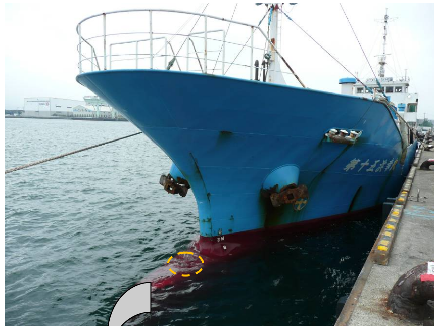
写真4 B船の球状船首部の損傷状況
