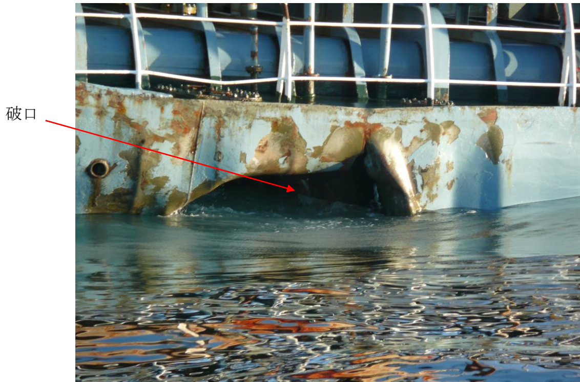
写真6 A船左舷前部の損傷状況
