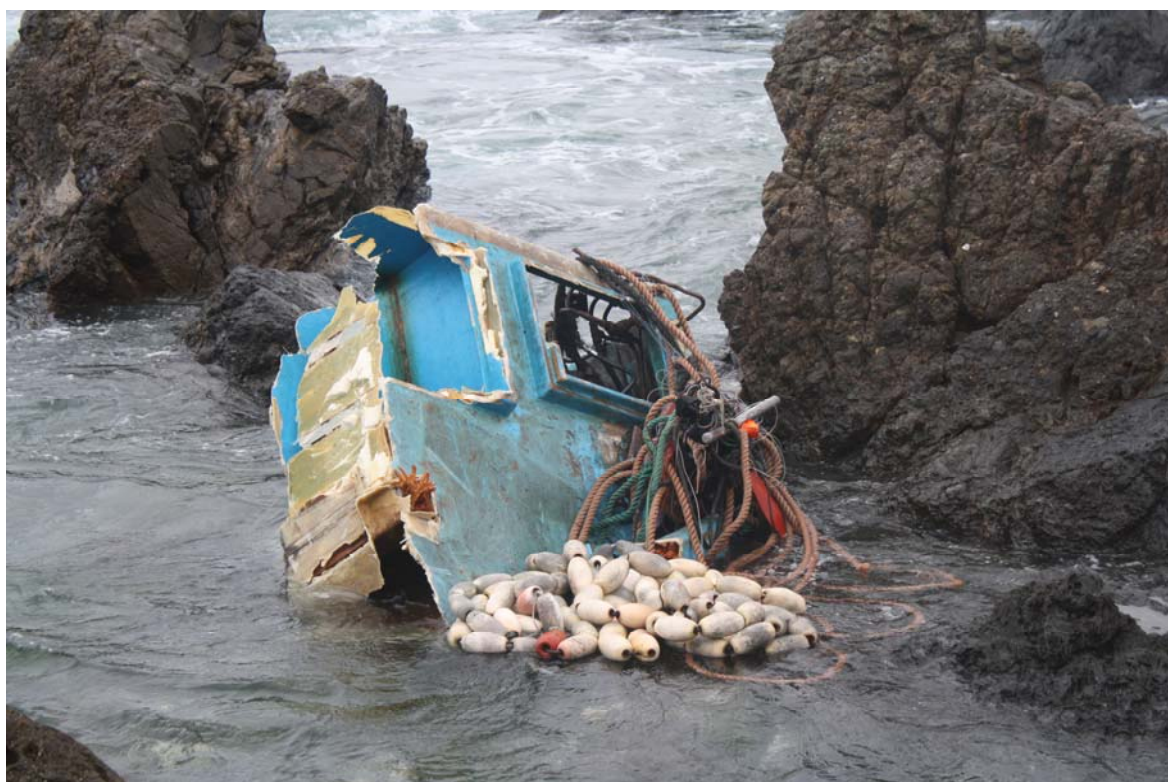
写真5 大破した本船（船尾部）
