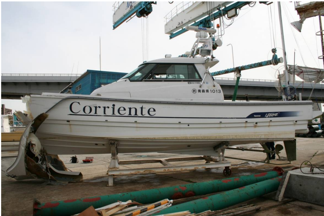
写真3 船首部の損傷状況③
