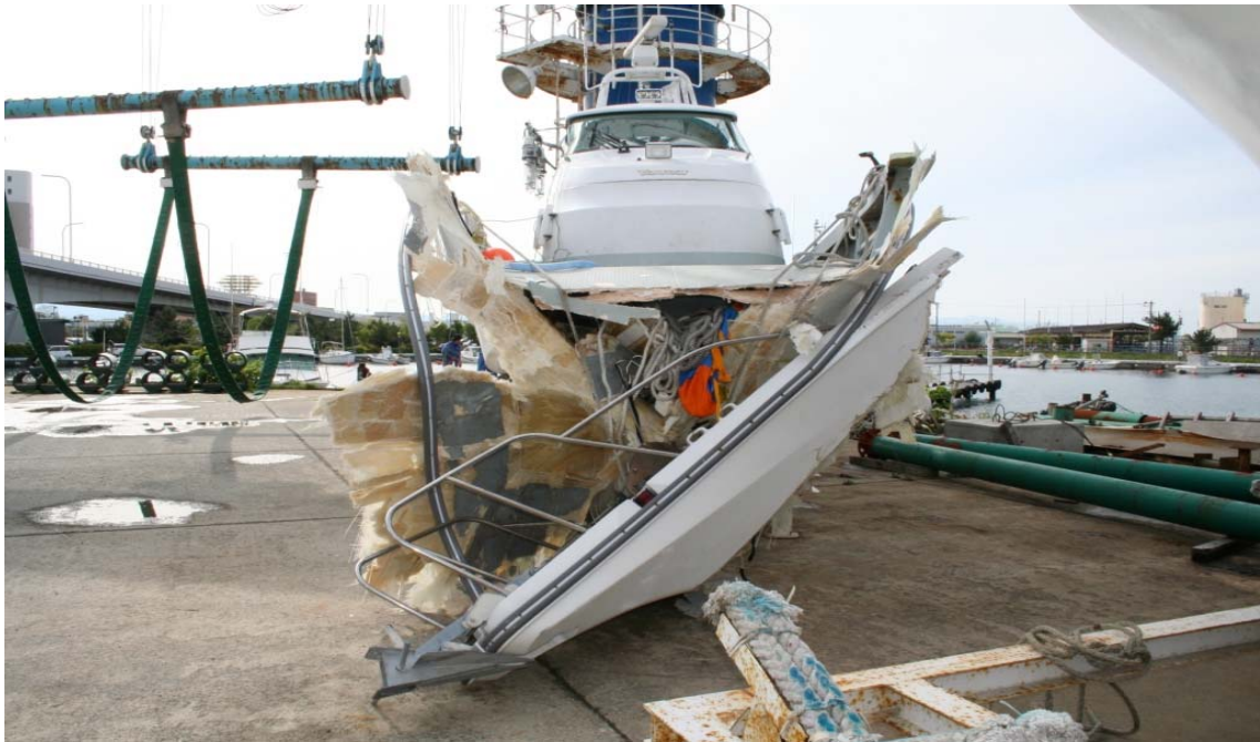
写真1 船首部の損傷状況①
