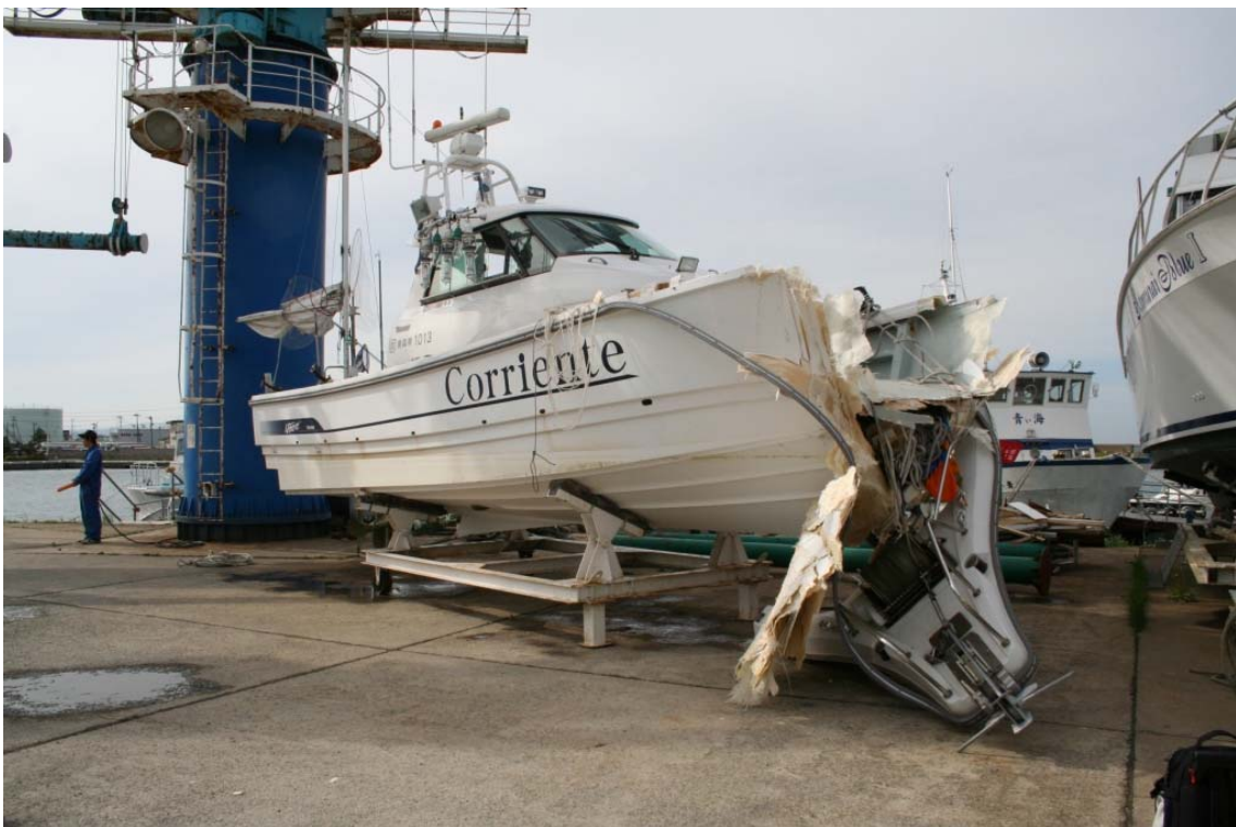
写真2 船首部の損傷状況②
