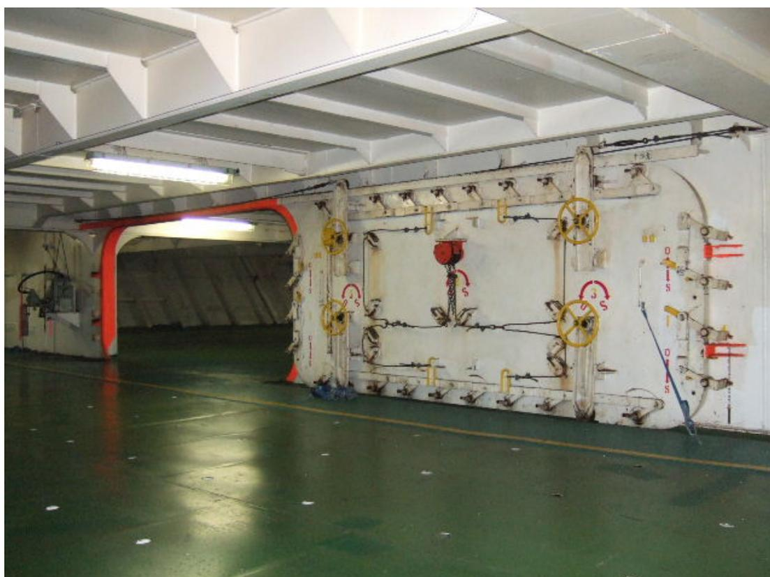
写真7 起倒式ガスタイトドア
