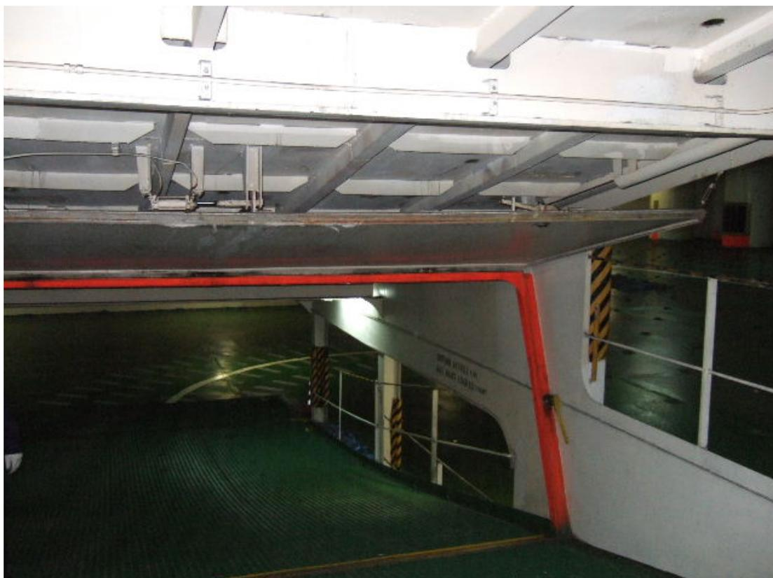
写真8 階段から車両甲板への防火扉
