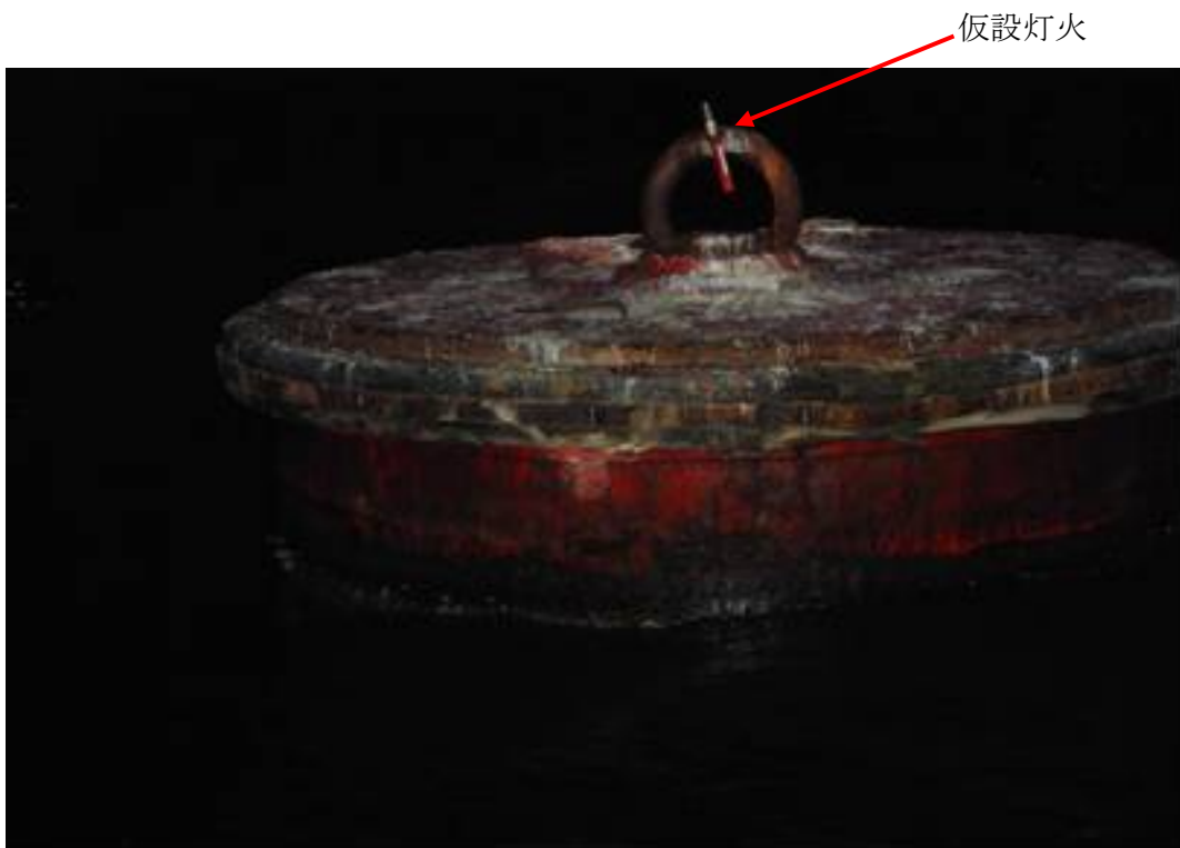
写真4 仮設灯火の状況
