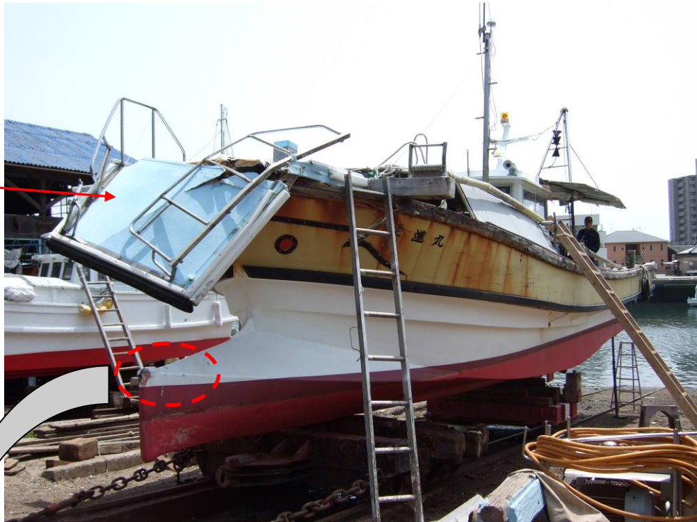
写真5 B船船首部の損傷(2)
