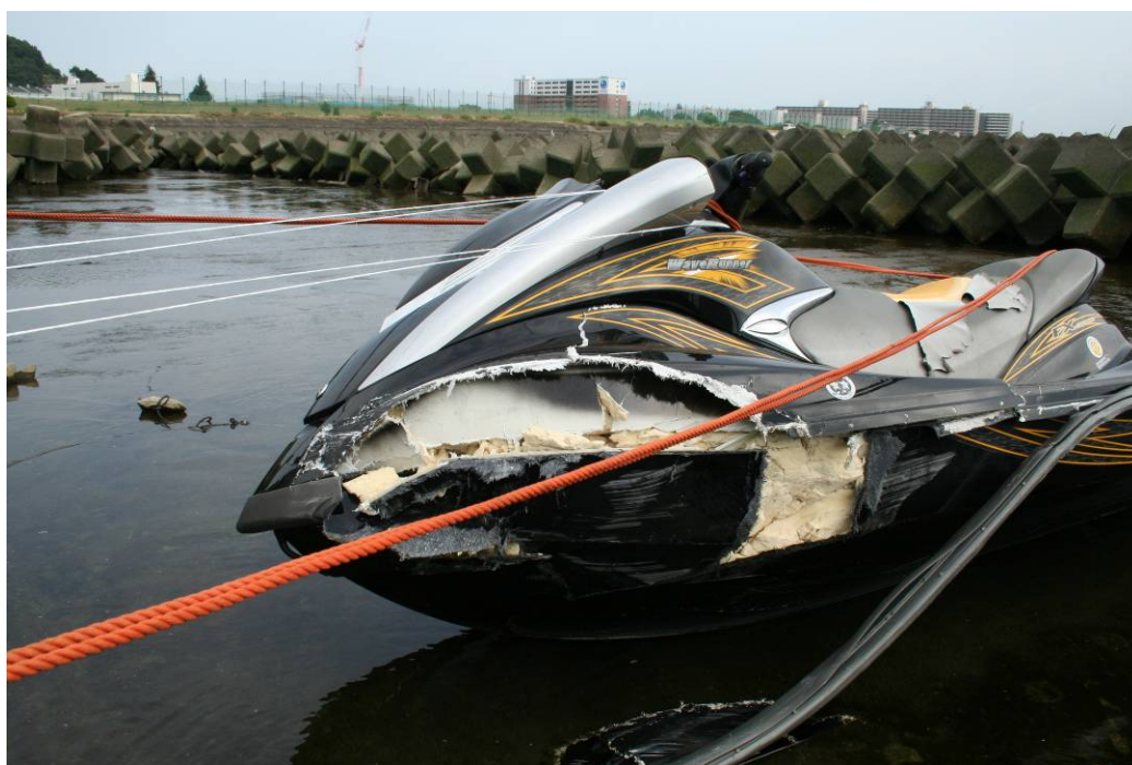
写真4 本船の損傷状況
