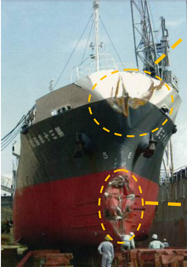
球状船首部の損傷
