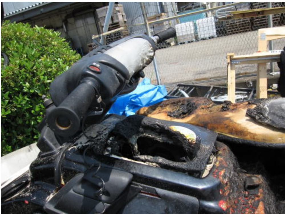
写真2 焼損した本艇
