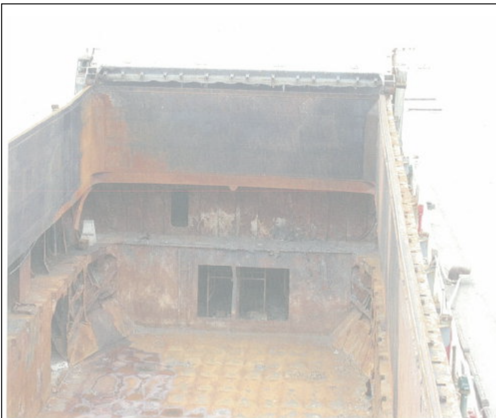
写真3 焼損した貨物倉内部
