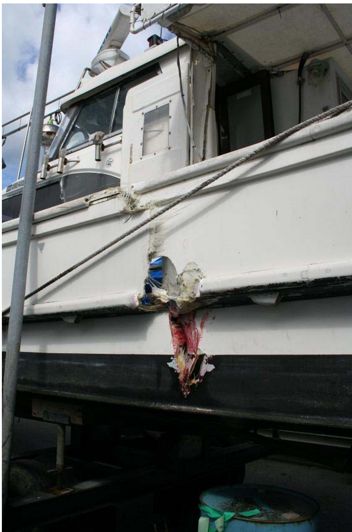
写真1 A船左舷側の損傷状況
