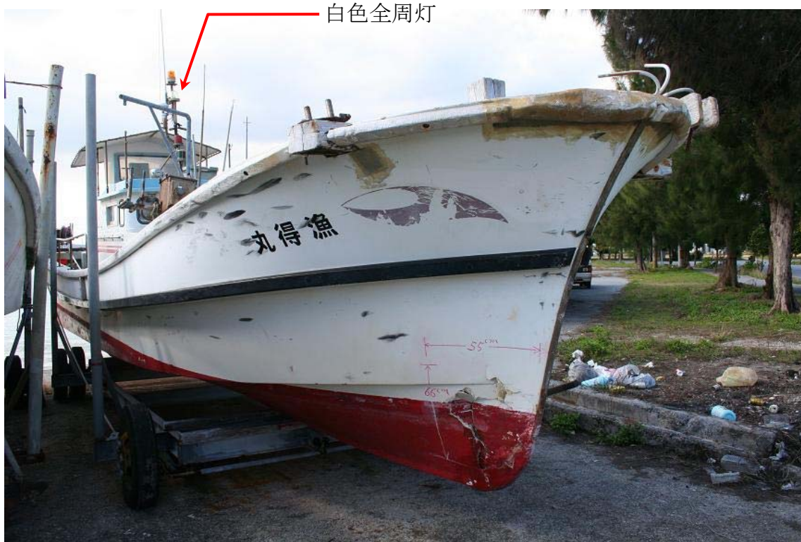
写真2 B船右舷船首船底部の損傷状況
