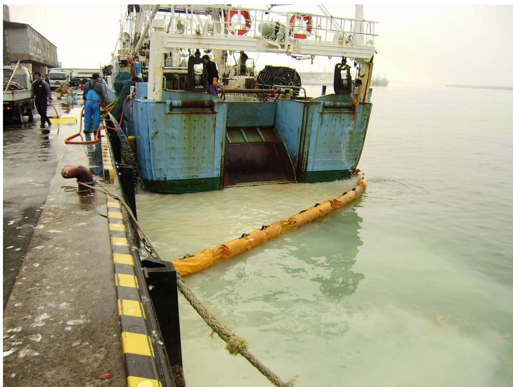
写真5 オイルフェンスの設置状況（船尾方）
