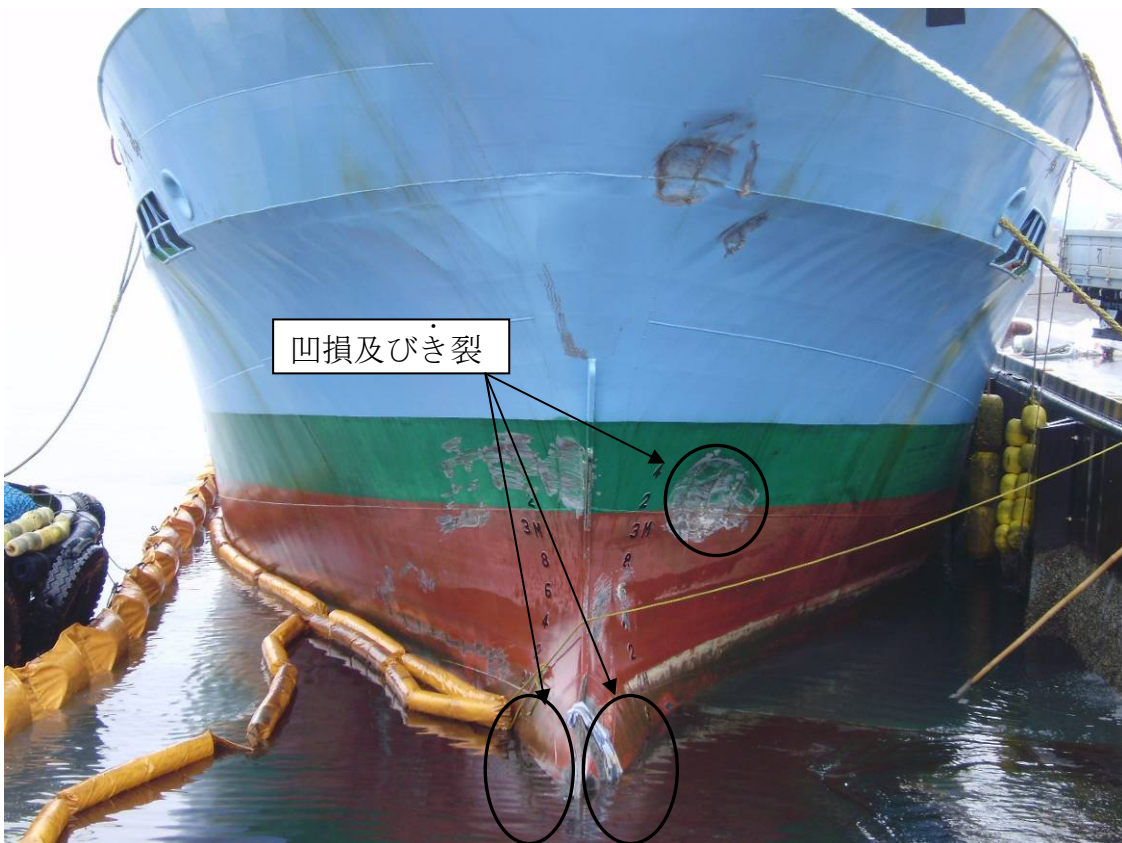
写真2 船首部損傷状況
