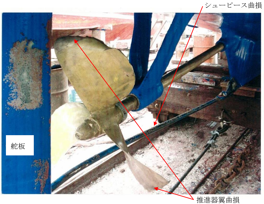
写真2 A船の損傷状況
