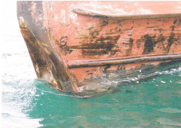
写真2 A船船首部の損傷
