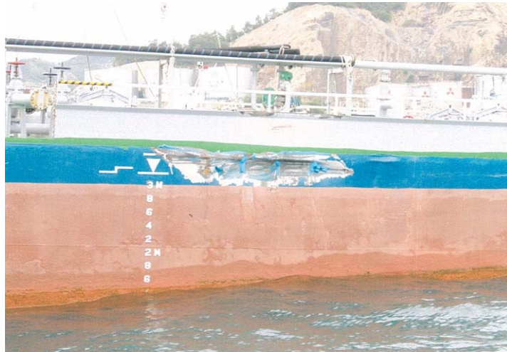
写真1 A船左舷中央部の損傷
