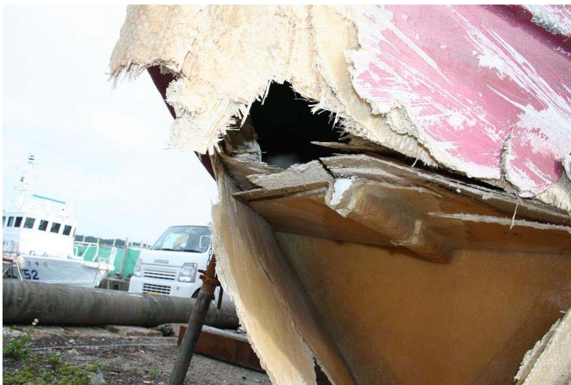
写真2 船首部の破口の状況
