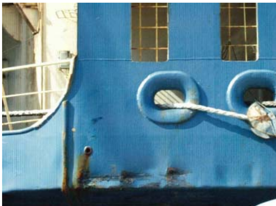
写真2 A船損傷状況（右舷船尾）
