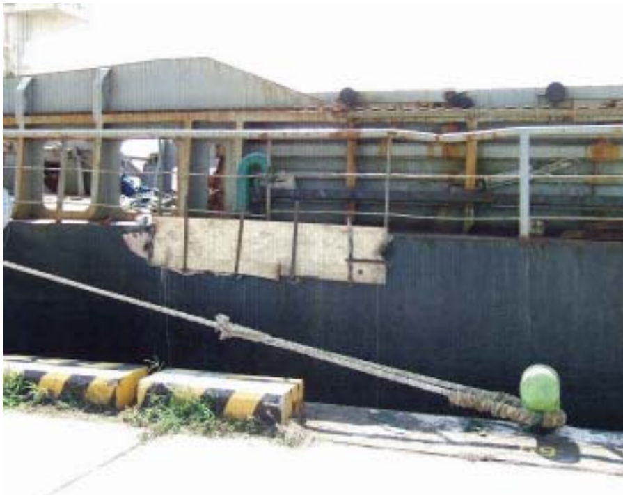
写真4 B船損傷状況（左舷前部）
