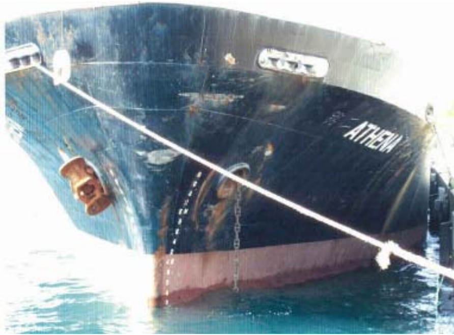
写真3 B船損傷状況（船首部）
