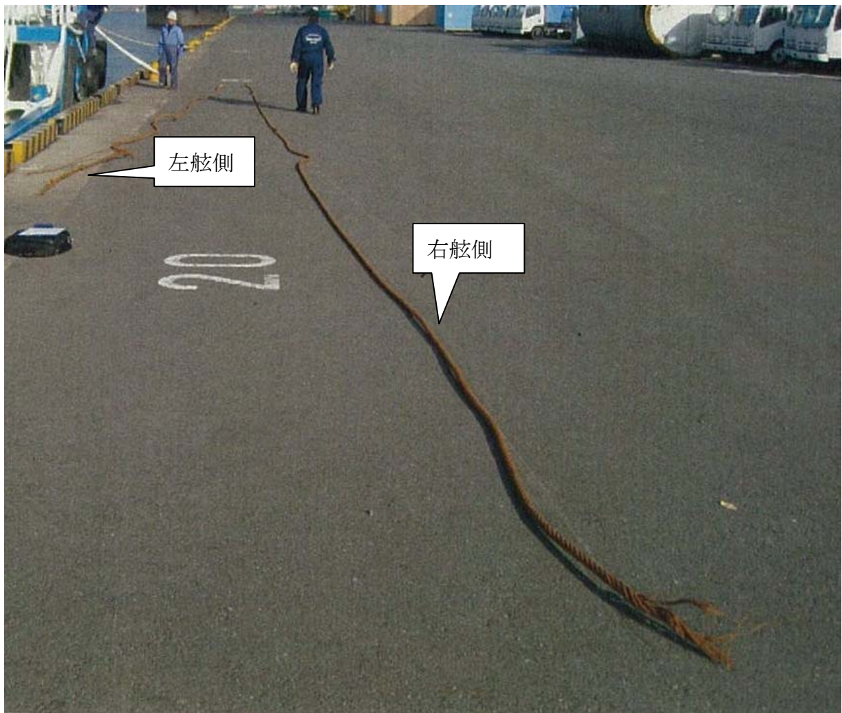
写真4 切断したブライダルワイヤ (その2)
