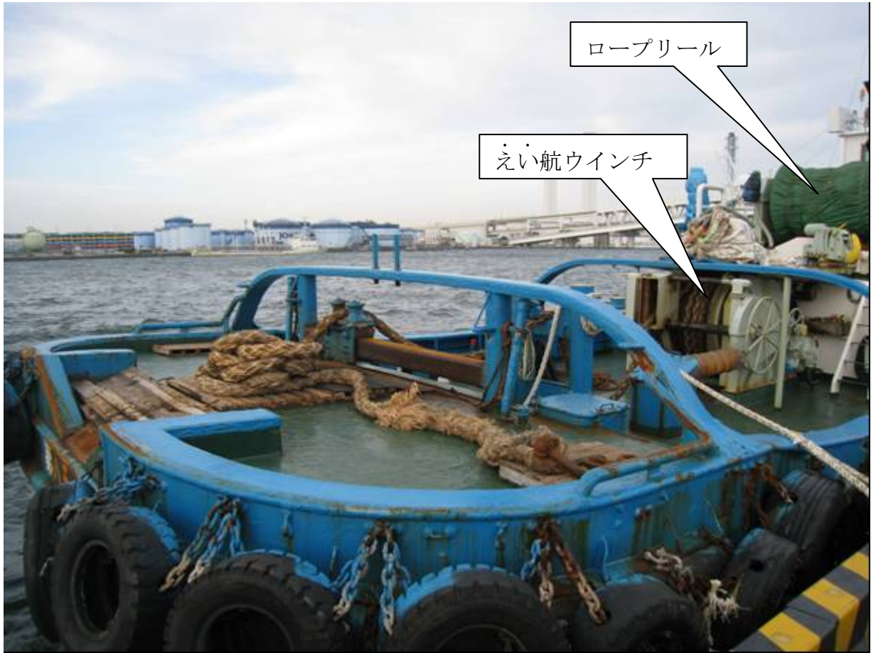
写真6 えい航ウインチ及びロープリール
