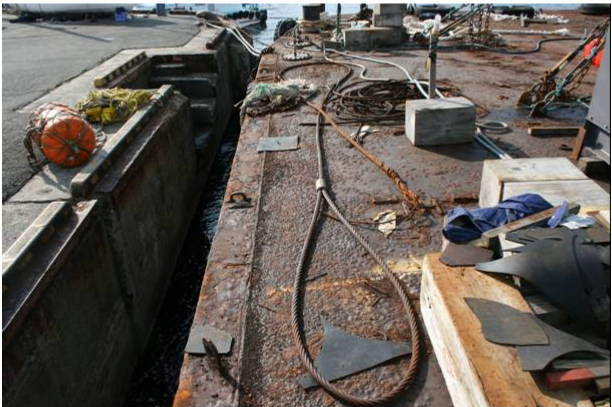
写真3 切断したブライダルワイヤ（その1）
