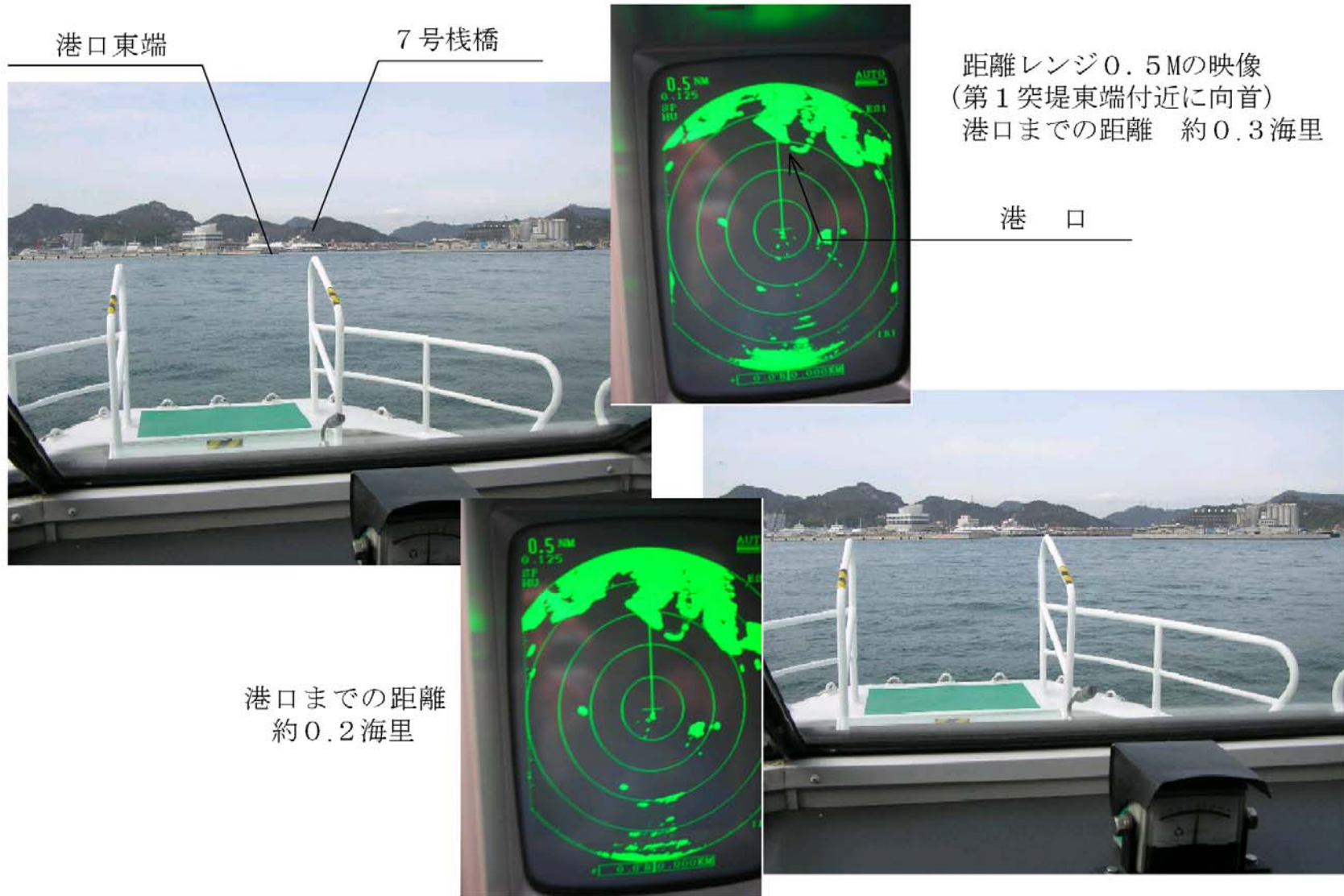
写真1 距離レンジ0.5Mにおけるレーダー映像及び実景（昼間）
