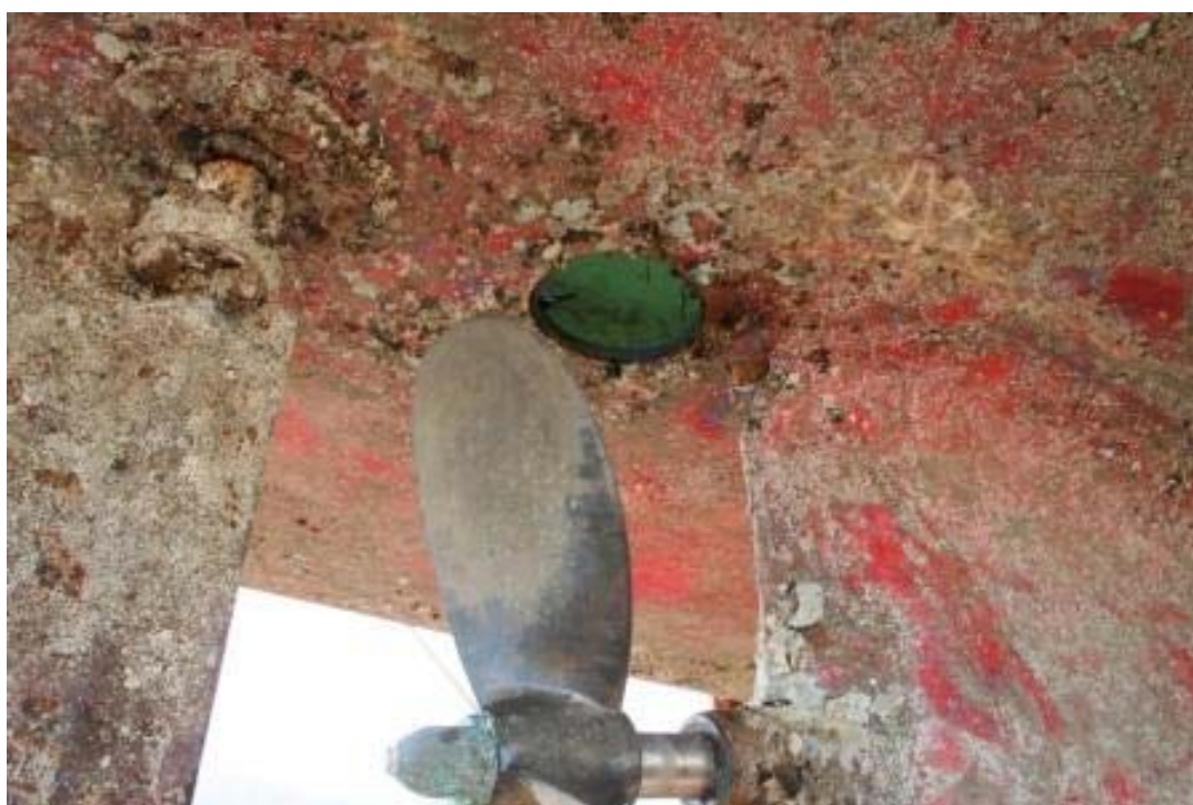
写真2 プロペラ点検口の状況
