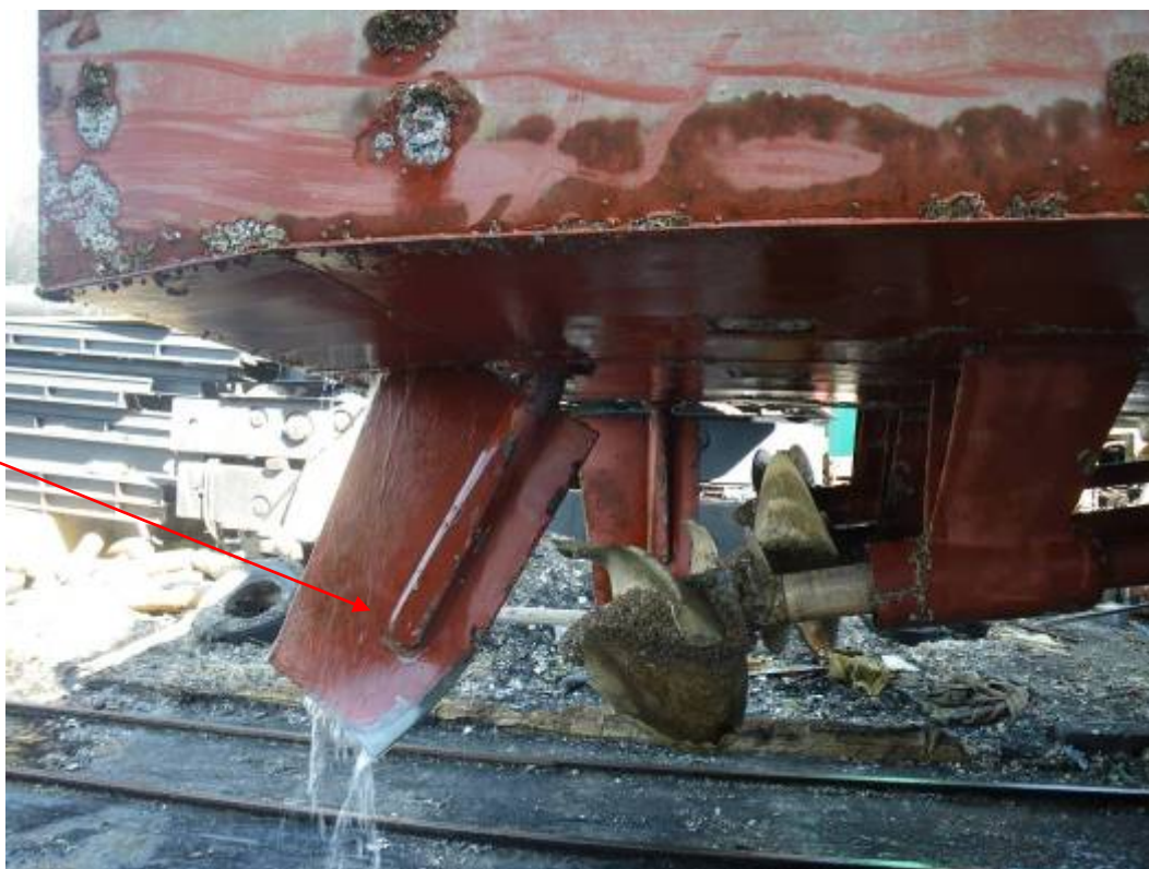
写真3 船尾の損傷状況
