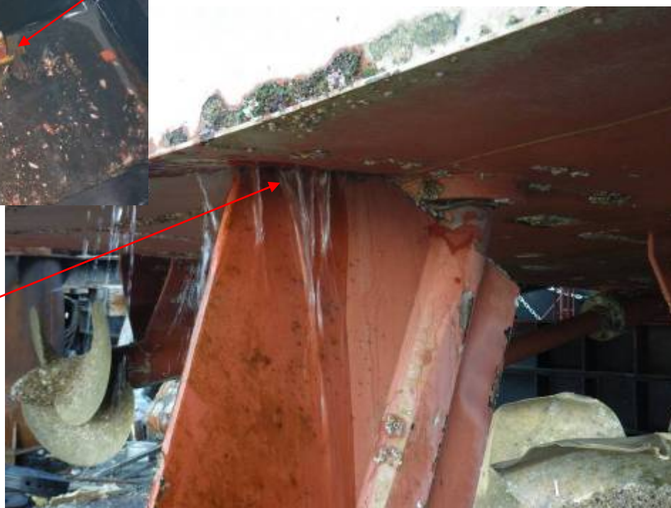
写真6 プロペラの損傷状況
