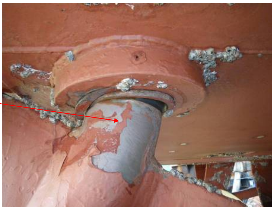
写真4 舵柱の曲損状況
