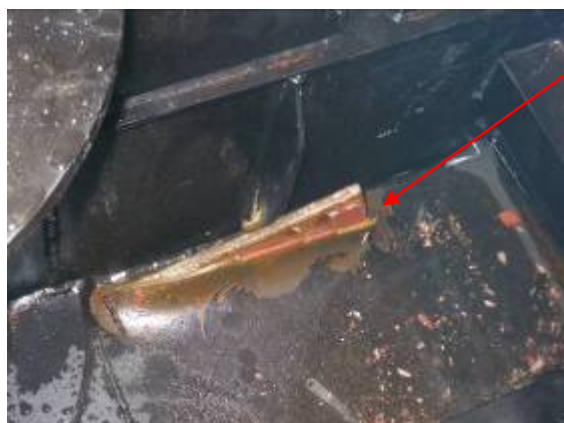
写真5 船底を突き破った舵板
