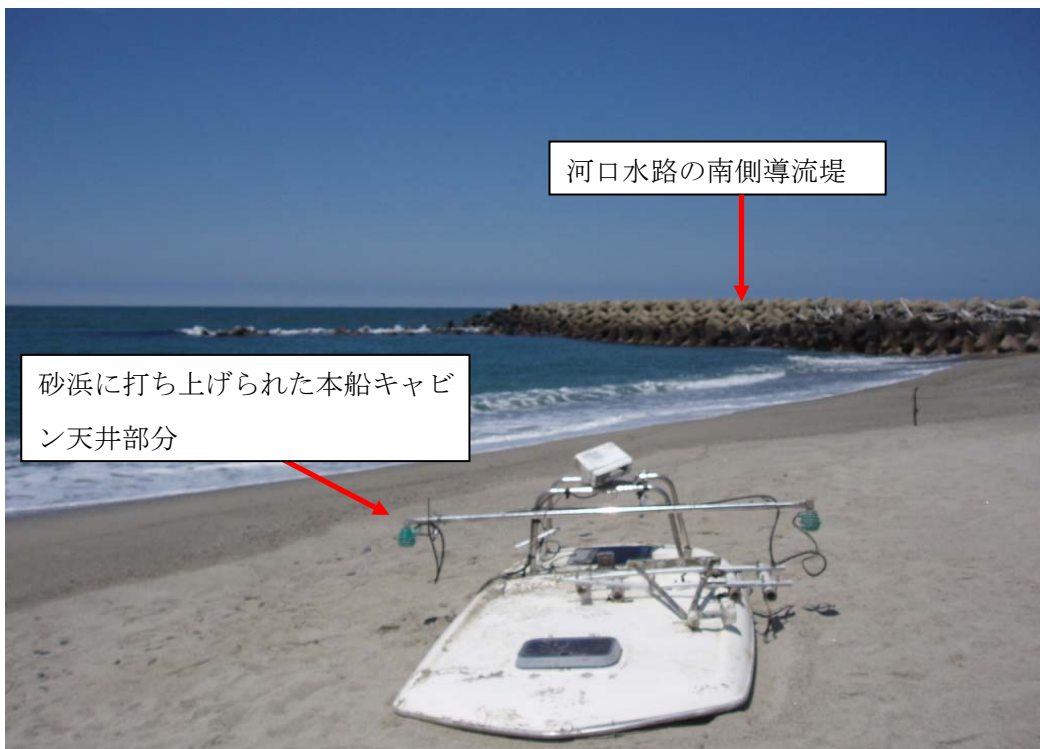
写真4 損傷状況（本船キャビン天井部分）
