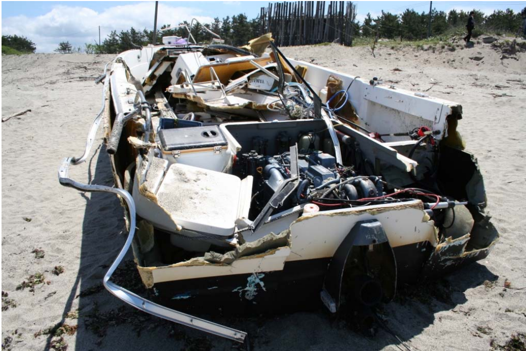
写真3 損傷状況（本船船尾部）
