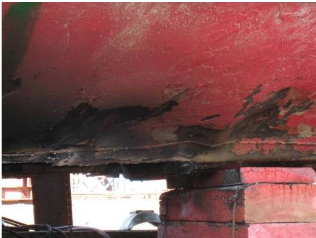
写真2 船底損傷（凹損）
