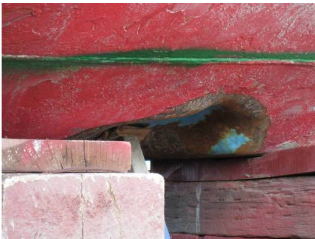
写真2 船底損傷（凹損）
