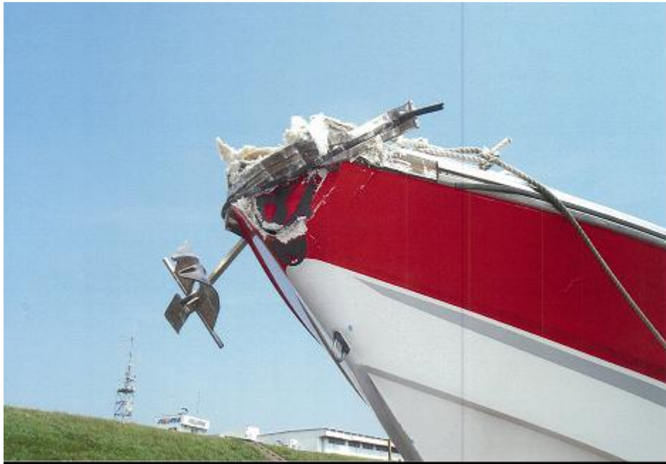
写真3 船首の損傷状況
