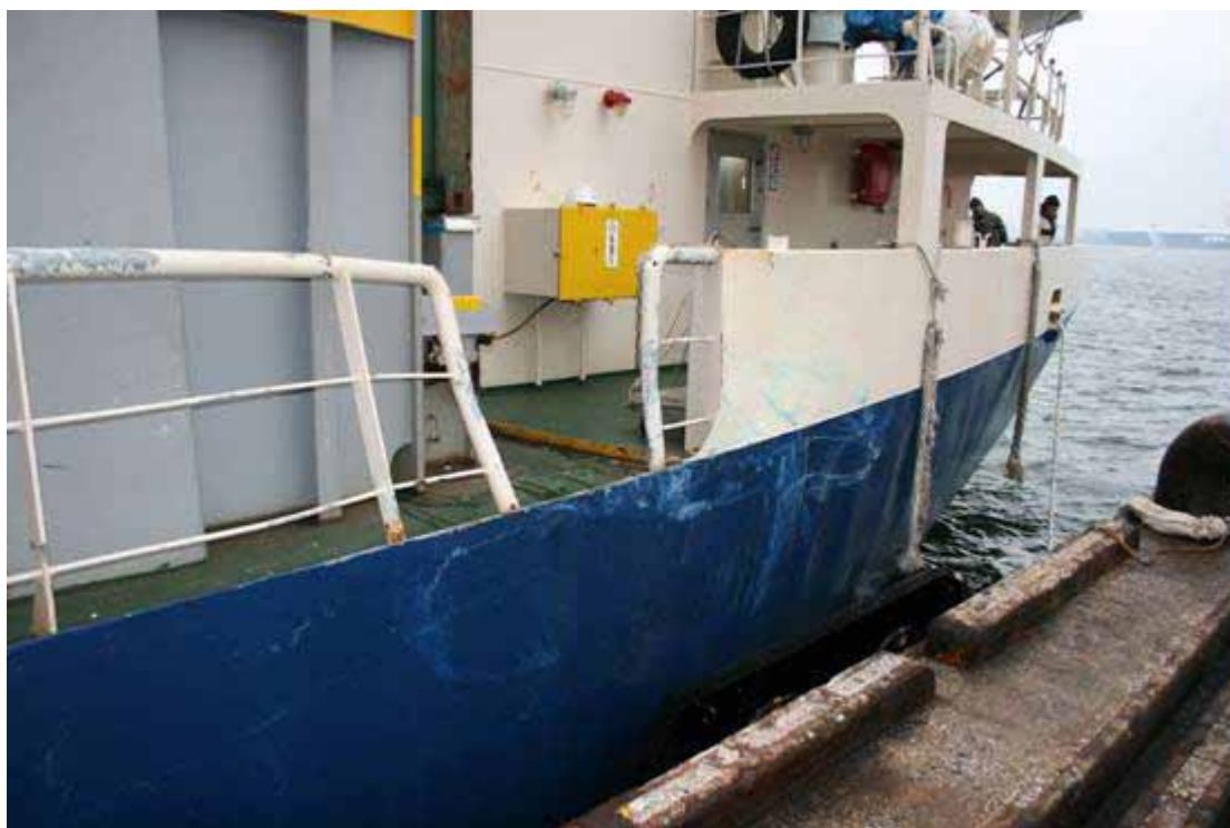
写真1 A船の左舷船尾ハンドレール曲損
