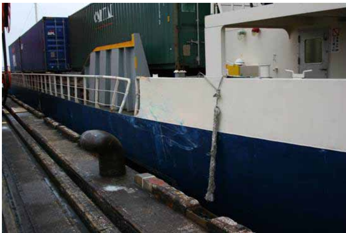
写真2 A船の左舷船尾側外板擦過傷
