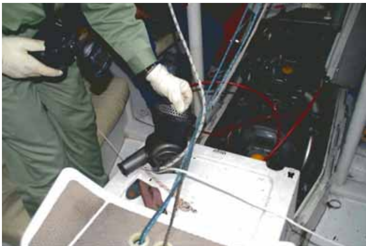
写真 1 3 吸気サイレンサ分解状況
