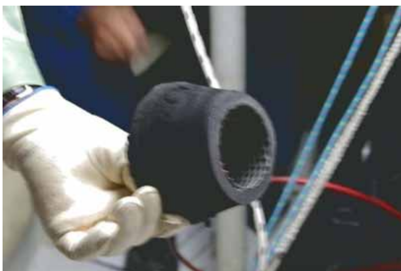
写真 1 4 吸気フィルタ損傷状況
