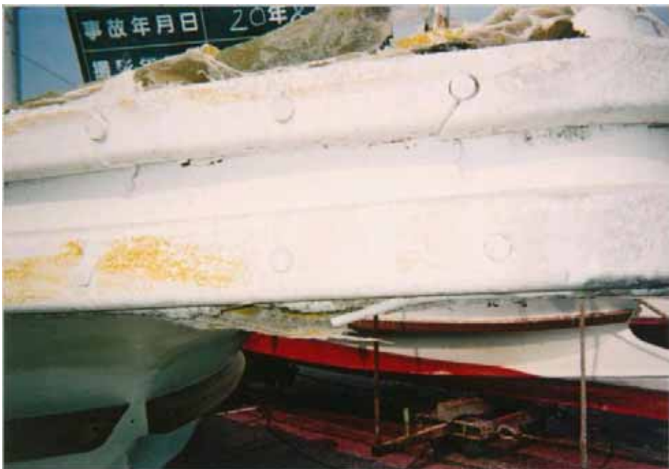
写真4 B船損傷状況（右舷船首甲板側面）
