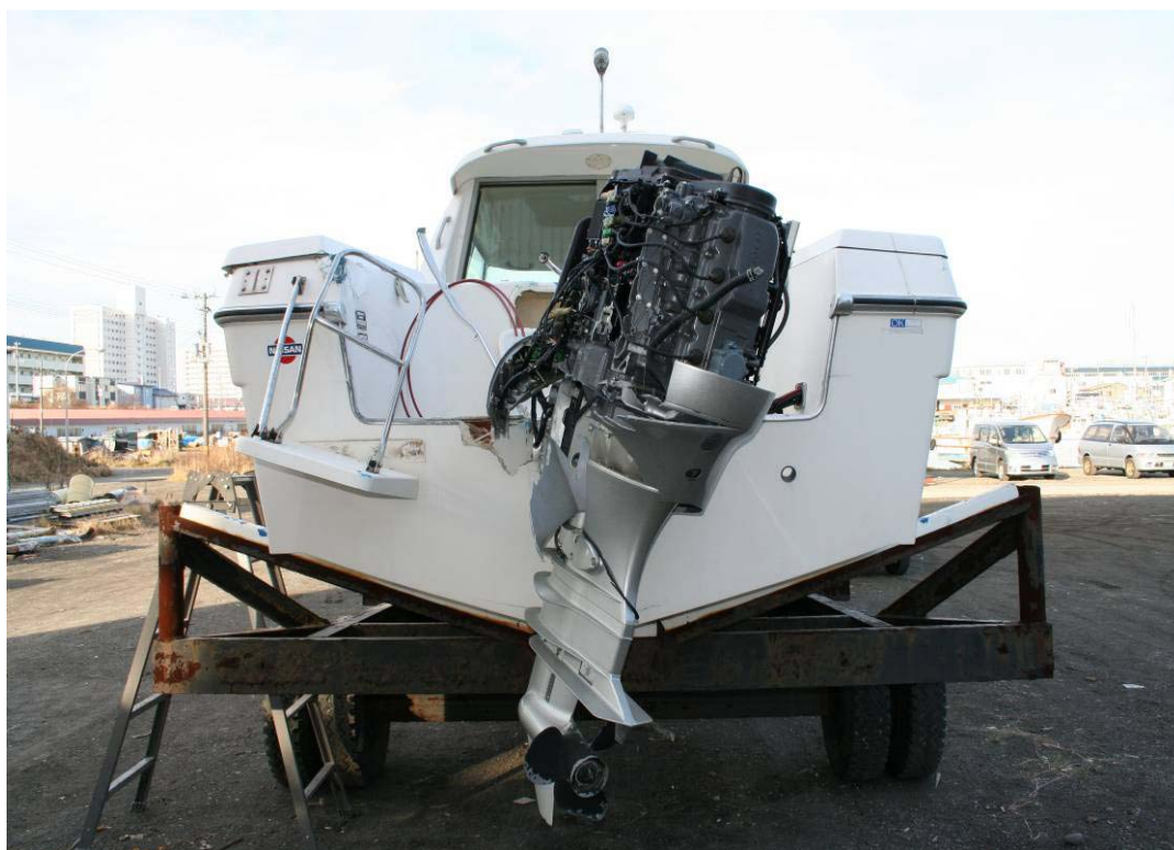
写真3 B船の損傷状況（船尾及び船外機）
