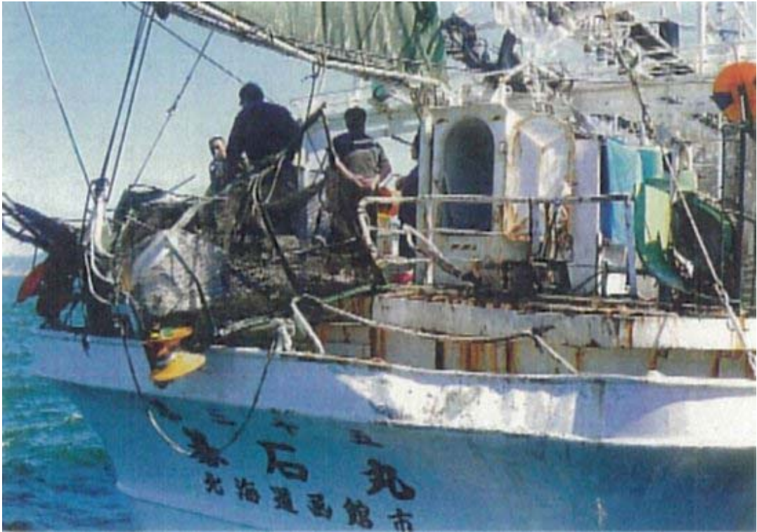
写真1 A船損傷状況（船尾部）
