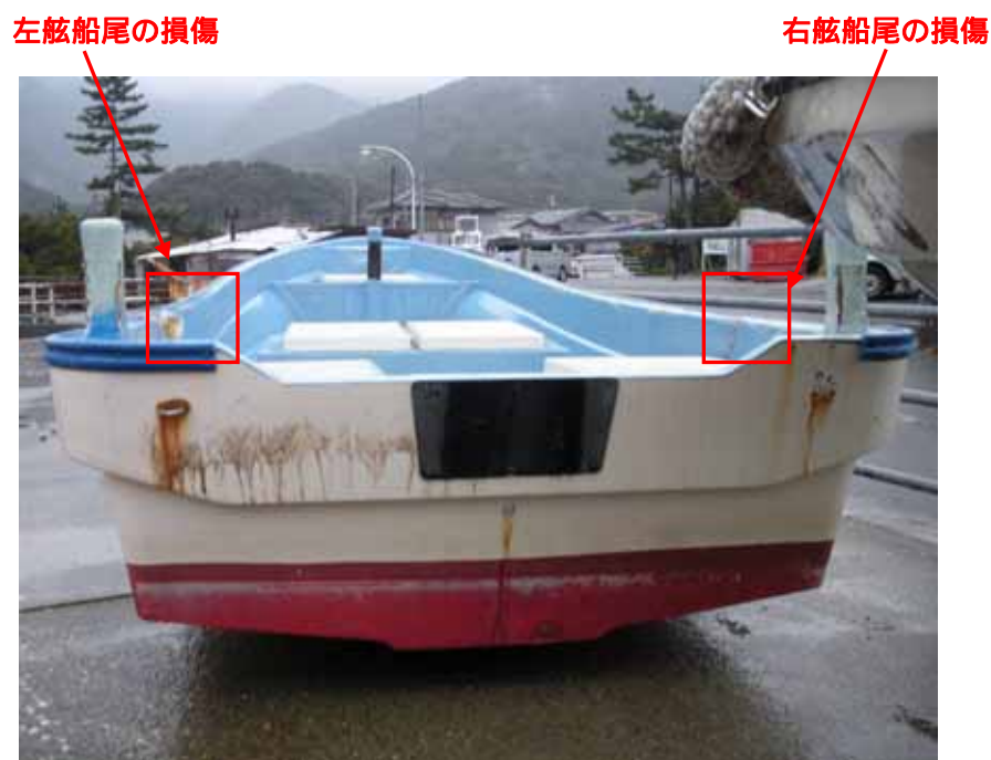
写真6 B船の正船尾の損傷状況
