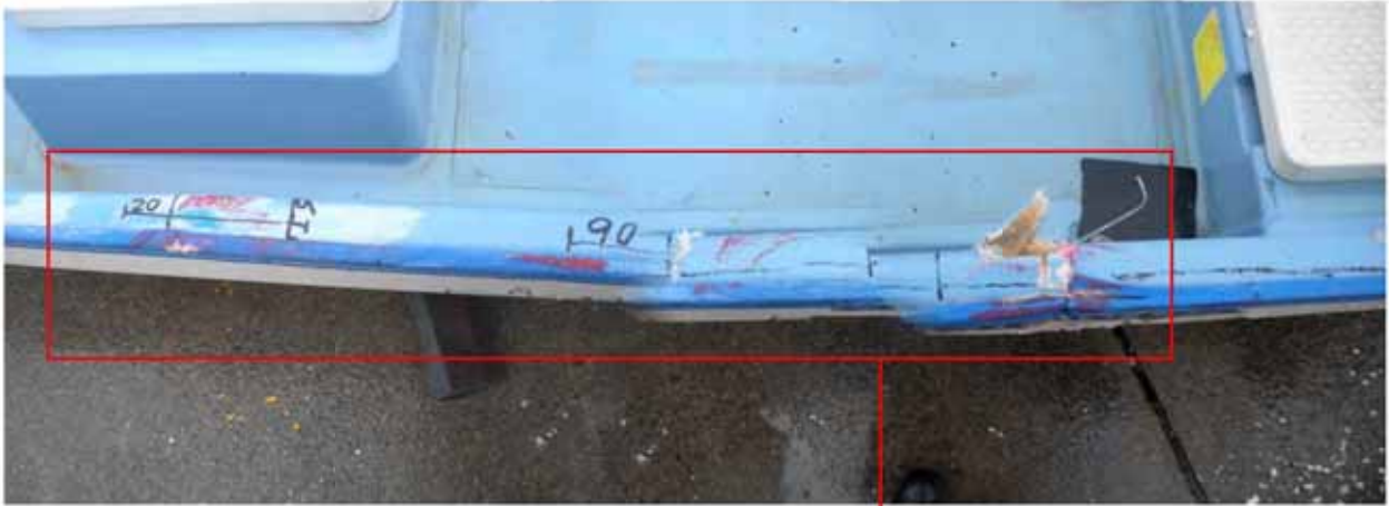
左舷船尾の損傷
