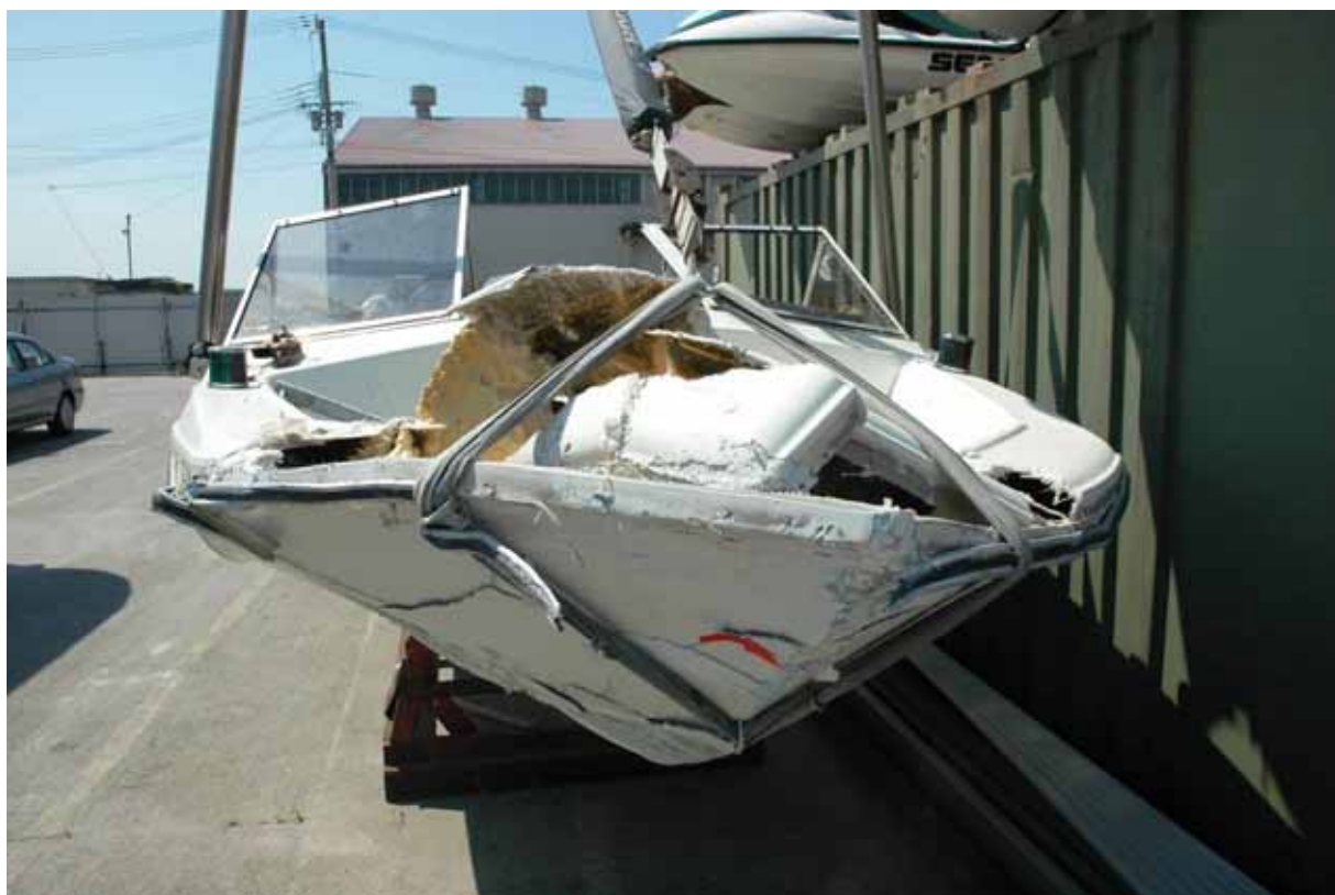
写真3 船首部の損傷状況
