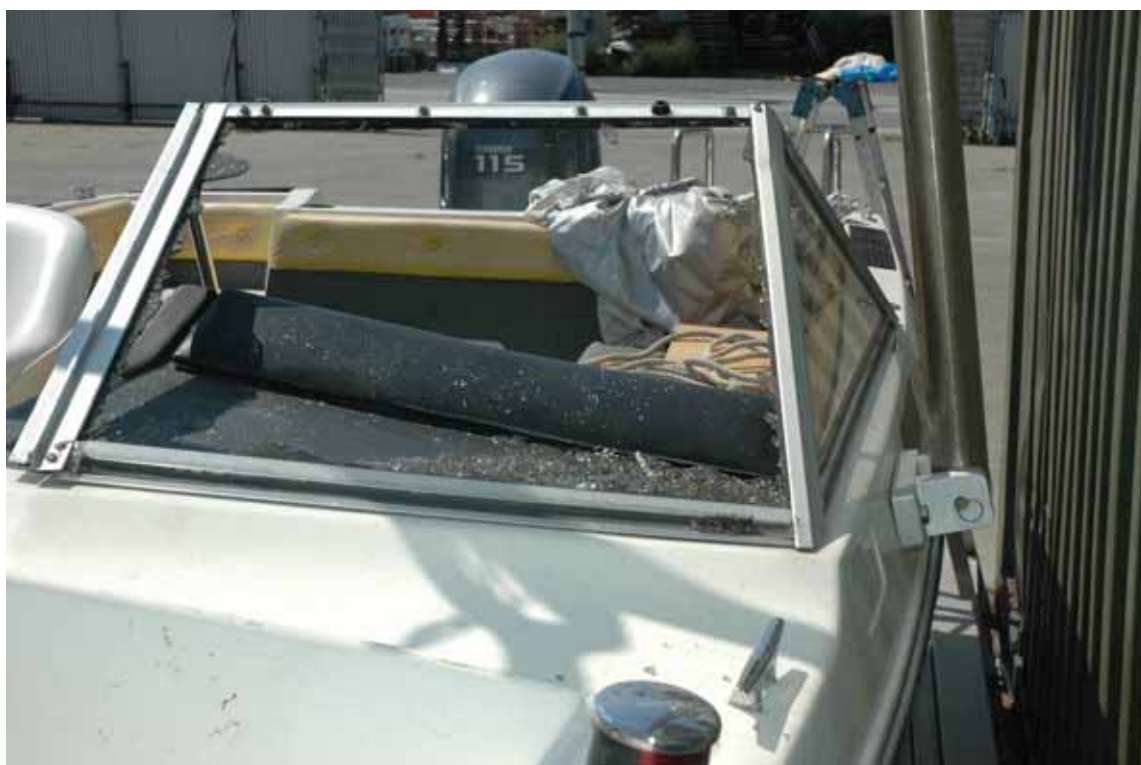
写真4 風防の損傷状況
