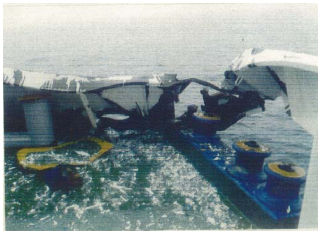
写真2 A船 右舷船尾部損傷（船内から船外を見たところ）
