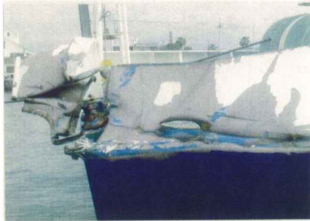
写真1 A船 右舷船尾部損傷（右舷船尾方向から）
