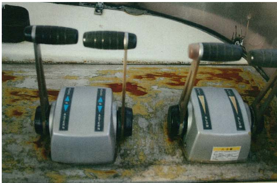
写真3 両舷機のクラッチレバー及びスロットルレバー
