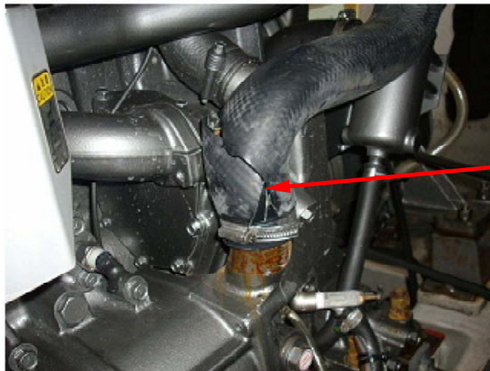
写真12 ゴム製管継手の破損状況 (取外し後)
