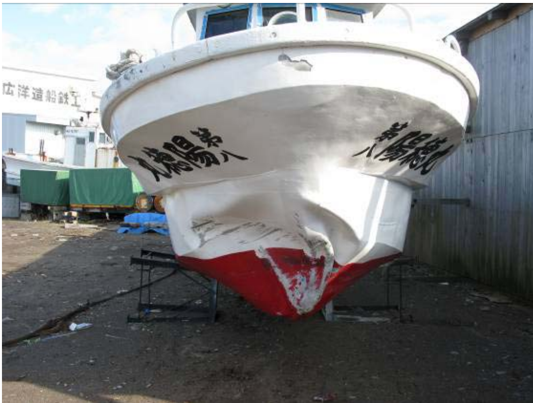
写真2 損傷状況（船首船底）
