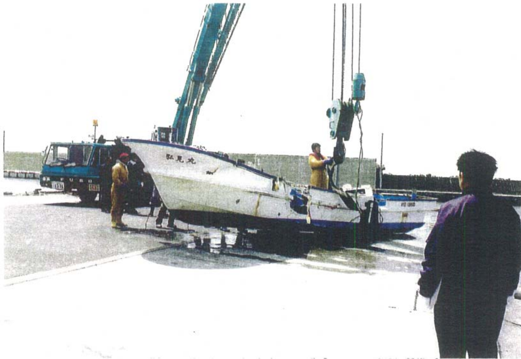
写真4 B船の損傷状況（右舷側を下に、船尾を手前にして横倒しになったところ）
